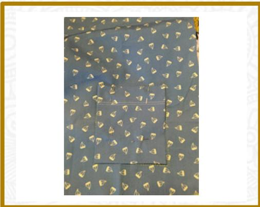
4. Coudre la poche sur son emplacement, côté gauche du devant, en surpiqûre recouvreuse 3 fils aiguilles C2 C3, longueur de point 3.
