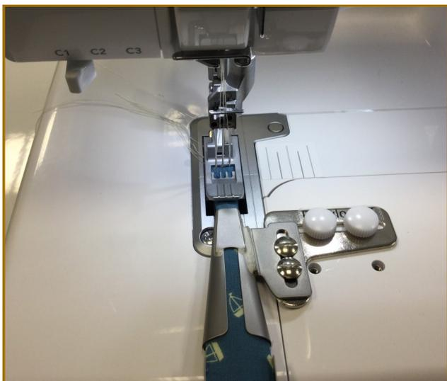
18. Poser votre guide passant à l'aide des deux vis blanches livrées avec votre machine en centrant l'aiguille C2 au milieu du passant.
