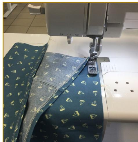
6. Enfiler votre Enlighten en 3 fils avec sur le boucleur supérieur un gros fil mousse, l'aiguille R et le boucleur inférieur: 2 fils classiques, sélecteur sur C, longueur de points 1(rolled) et largeur sur M. Piquer votre surjet étroit en haut dans le sens de la largeur sur l'endroit.
