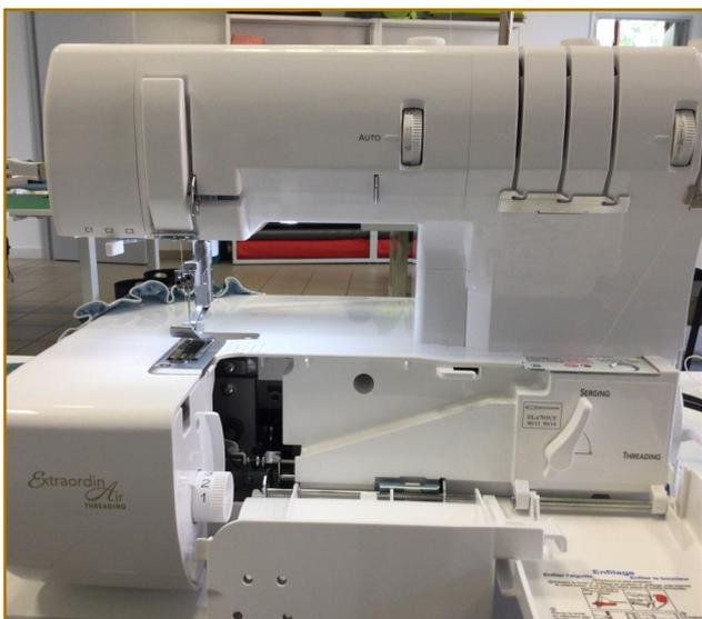
14. Enlever l'aiguille C3 puis mettre la tension du boucleur sur 4, la tension de l'aiguille restante (la C2) sur +1.5 et votre longueur de points à 1.5.
