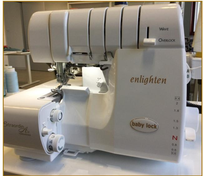
22. Enfiler votre enlighten en 4 fils , sélectionner sur A longueur de points 2,5 et largeur M, le couteau en fonction. Piquer à 1 cm du bord du tissu, l'Enlighten coupera le surplus de tissu.
