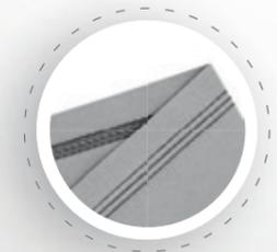
**Point de recouvrement 4 fils 6 mm**
