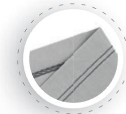
**Point de recouvrement 3 fils 3 mm**
