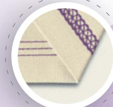
**Point de recouvrement 4 fils 6 mm**
